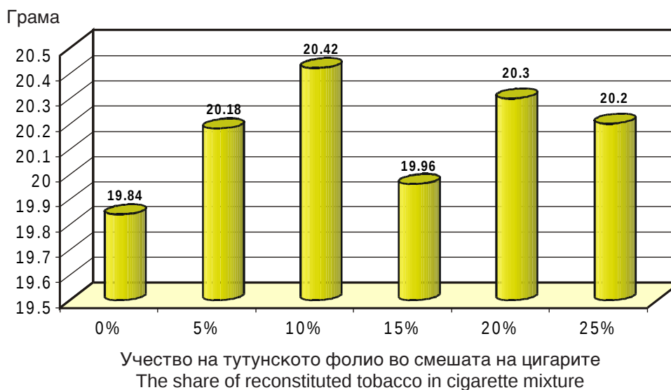
Графикон 10 - Влијание на тутунското фолио со циклонска прашина врз бројот на повлекувања Fig. 10 The effect of reconstituted tobacco with cyclone dust on the number of puffs
